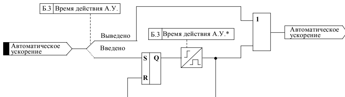
Рисунок 1.3.9 - Временная циклограмма формирования сигнала "Автоматическое ускорение"
